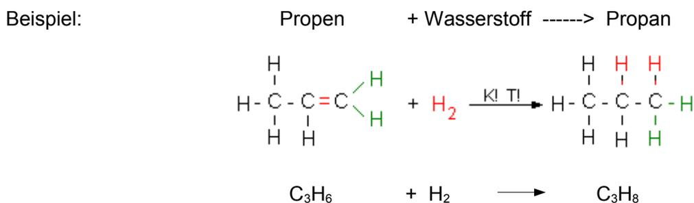
a) Stelle die Reaktionsgleichungen mit Summen- und Strukturformeln für die Hydrierung von Ethen, Hepten, Penten und Ethin auf!
